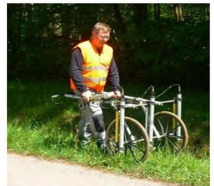
Figure 1 : Photo de la prise de mesures au magnétomètre fluxgate 3 sondes.
