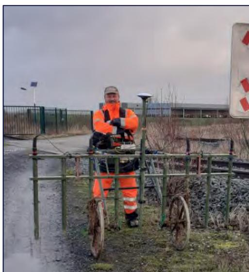
Figure 11: Magnétomètre 5 sondes Sensys
