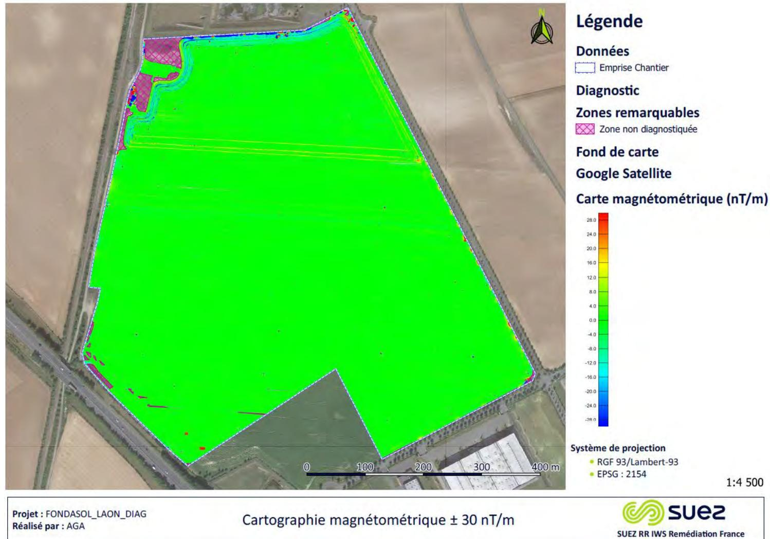
Figure 17: Cartographie issue du diagnostic du champ magnétique local à une échelle +/- 30 nT/m
