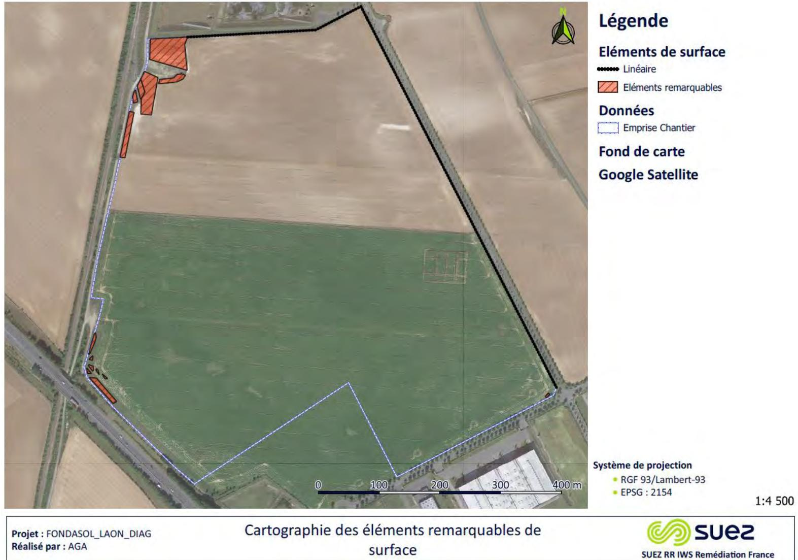
Figure 13: Cartographie des éléments de surface susceptibles d'altérer les mesures géophysiques
