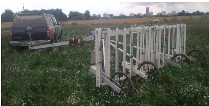
Figure 3: Photo de la prise de mesure au magnétomètre fluxgate 8 sondes.
