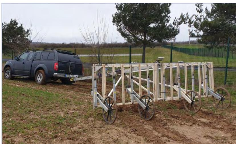
Figure 10: magnétomètre 8 sondes Sensys
